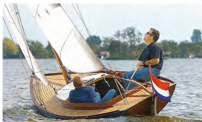
Historisches Überbleibsel. Das positive Spiegelheck mit dem angehängten Ruder galt vor 80 Jahren noch als revolutionär
