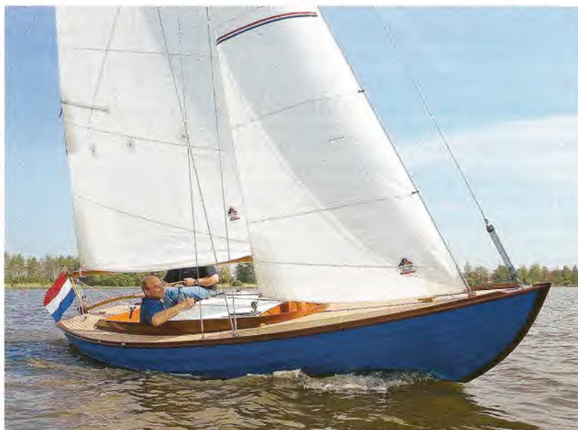
Typisch Folkeboot. Ausgeprägter Sprung, Löffelbug, Klinkerbauweise
